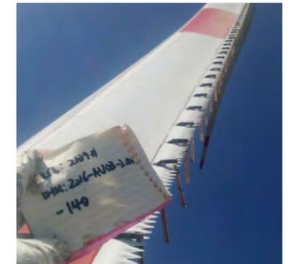
部分风机叶片实施降噪改造（设置锯齿尾缘）
