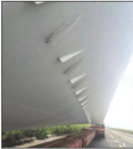
图 5-1 叶片涡流发生器安装示意图
